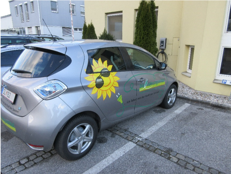
Elektroauto mit dazugehöriger Ladestation (Tankstelle)
